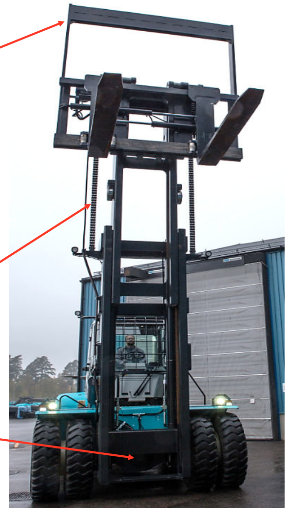
Додаткові направляючі колеса щогли та бічні опори (8 коліс + 8 опор)
